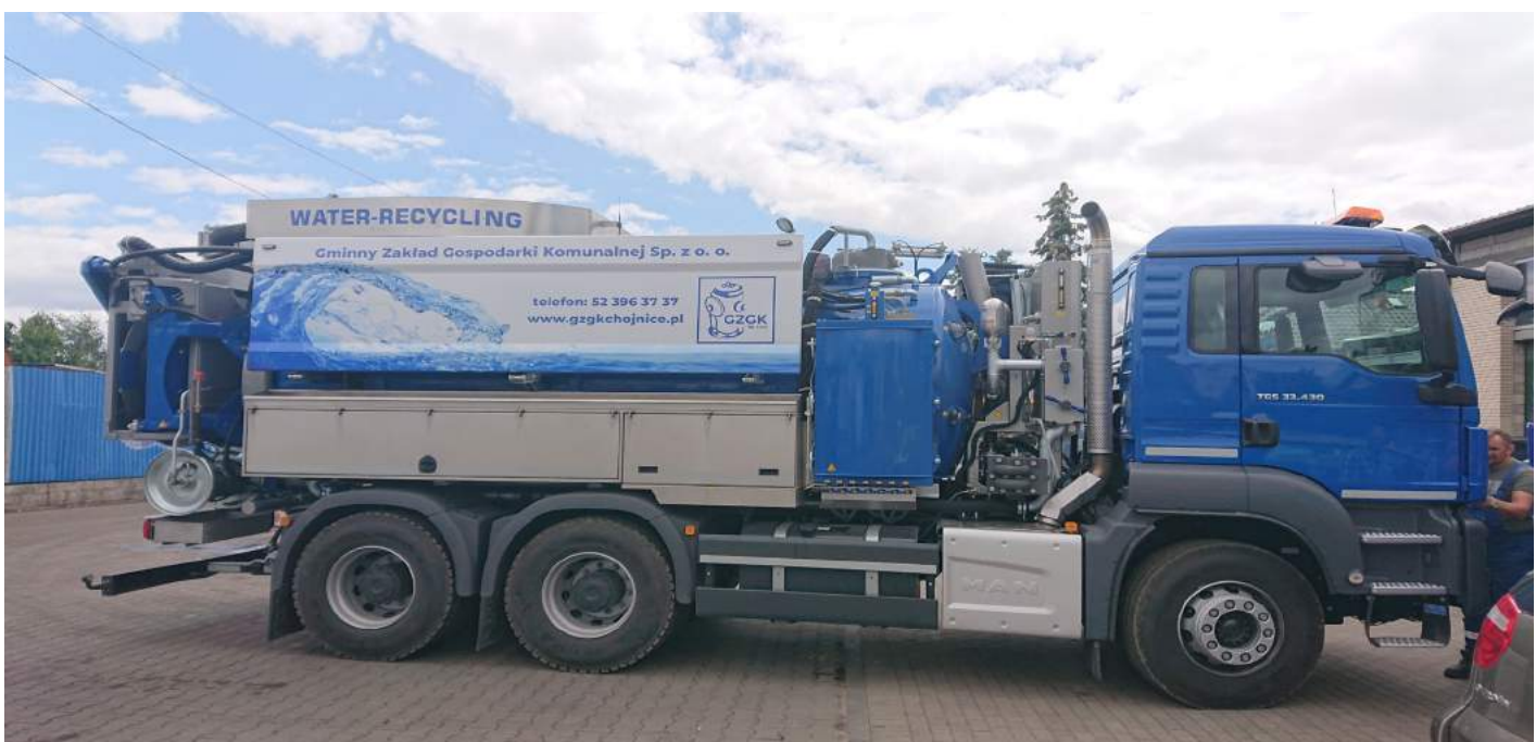
Samochód specjalistyczny do ciśnieniowego czyszczenia kanalizacji sanitarnej
